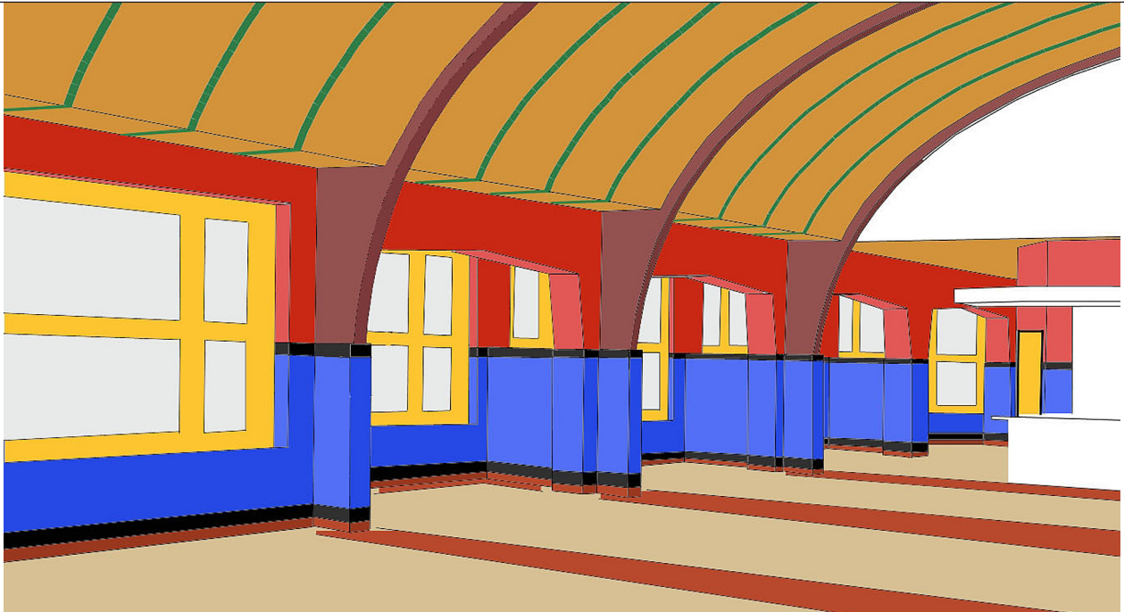
Afb. 3. Schetsmatige reconstructie van de kleurafwerking in het restaurant bij de aanvang in 1931. (Tekening: BAM, M. Enderman)
